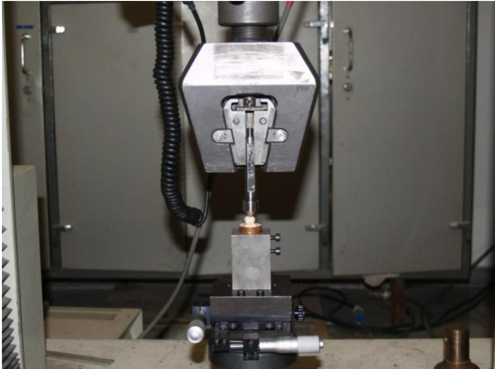
Figura 5. Abrazadera del aplicador de la carga y mesa de fijación de los especímenes
