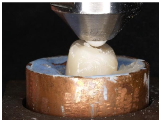
Figura 6. Fractura de la porcelana de recubrimiento tras someterla a carga.
