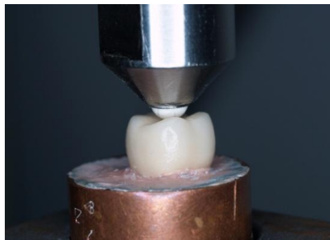
Figura 4. Contacto entre antagonista y vertientes internas de la muestra.
